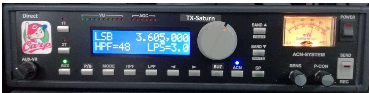
周波数表示値の下にアンダーバー（\_）表示となっている場合が、ノーマルモードです、この時エンコーダーを廻すと、この例の場合は1kHz単位がUP/Downします、UP/Downさせる桁を変える場合は'←'、'→'キーで移動させます。何かを操作する場合はノーマルモードに戻してから行うこと。受信状態でのメーター表示は、キャリアレベル表示となっています。通常、70前後に針は位置しています、もし、これがフルスケール等に針が振れれば、キャリアヌルが異常であることを示します。
