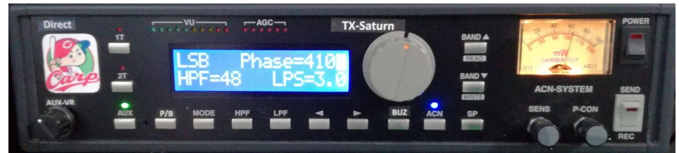
更に'PH／PB'キーを押すとBalanceモードとなります。エンコーダーを廻し、逆サイド信号が最小となるように調整します。PhaseとBalanceを交互に調整し最小にします。最後にノーマルモードに戻すことにより調整値が書き込みされます、本調整をLSB／USBモードにわたり全バンドにたいして行い、調整値をメモで残しておいた方が良い（初期化時に）、データーの書き込みは、各バンド／モードにて値をセットしノーマルモードに戻せばよい。
