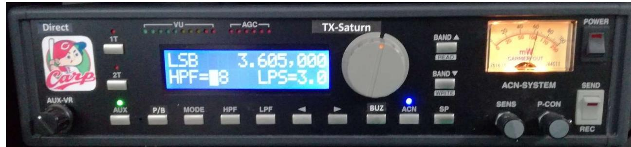
'HPF' キーを押すとカーソルが、数値位置で点滅します、この時エンコーダーを廻せばカットオフの切り替えが出来ます。ノーマルモードに戻すには、再度' HPF' キーを押します。
