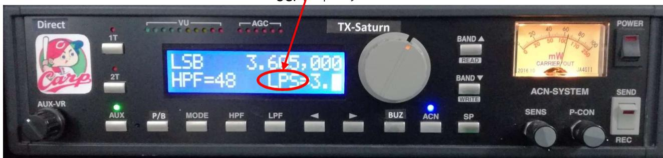
'LPF' キーをおすとLPFモードとなります、2行目の右端でカーソル点滅している状態が、LPFモードです。この時エンコーダーを廻すとカットオフ値が変更出来ます。又、LPFの種類はスイッチドキャパシタ (SCF) フィルターとアクティブフィルターの2種類に対応しており、LPS=SCFフィルターで、LPA=アクティブフィルターであることを示します。この種類を変更するにはLPFモードで' SP' キーを押すと交互に切替ります、ノーマルモードに戻すには、再度' LPF' キーを押す。
