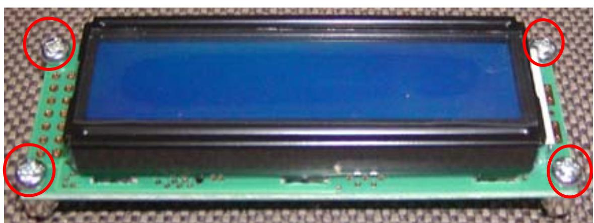
・LCDの取り付け穴4ヶ所を $\phi$ 3.2で拡大する。
