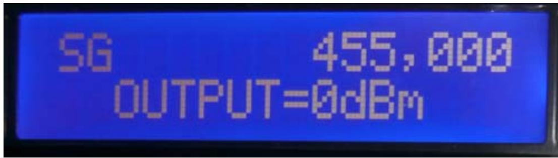
SGとして動作します。' 10' キーにより任意の周波数を入力し、Hz／KHz／MHzキーのいずれかで、周波数Fixされます。出力端子からは50Ω出力で、0dBmレベルで出力されます。
