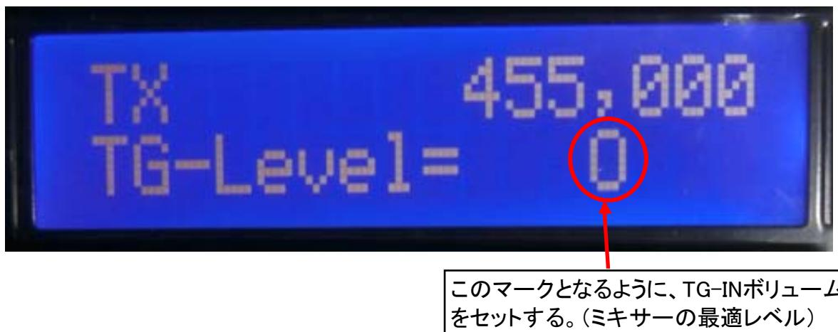
RL-Monitorの出力は、被測定物(送信機／変調器)の音声入力へ接続しますがこのレベルは、被測定物に対して最適レベルとなるように、AF-OUTボリュームでセットします。リミッターアンプ等を経由していれば、10dB位制限されるレベルが妥当と思います。
